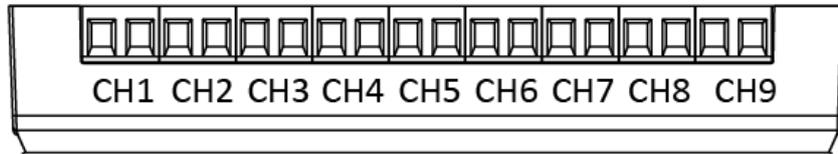
Der Video-/ Audioverteiler verfügt über neun 2 Draht-Anschlüsse für den Anschluss von einer Türstation und bis zu 8 Innenstationen.
